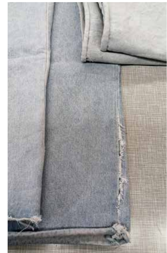
Fehlerhafte Nahtstelle bei der Jeansproduktion. Foto: Anja Leshoff.
